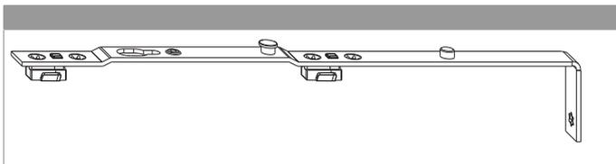
Dreh- Kippbandstulpe in die Beschlagsnut einlegen und verschrauben!
