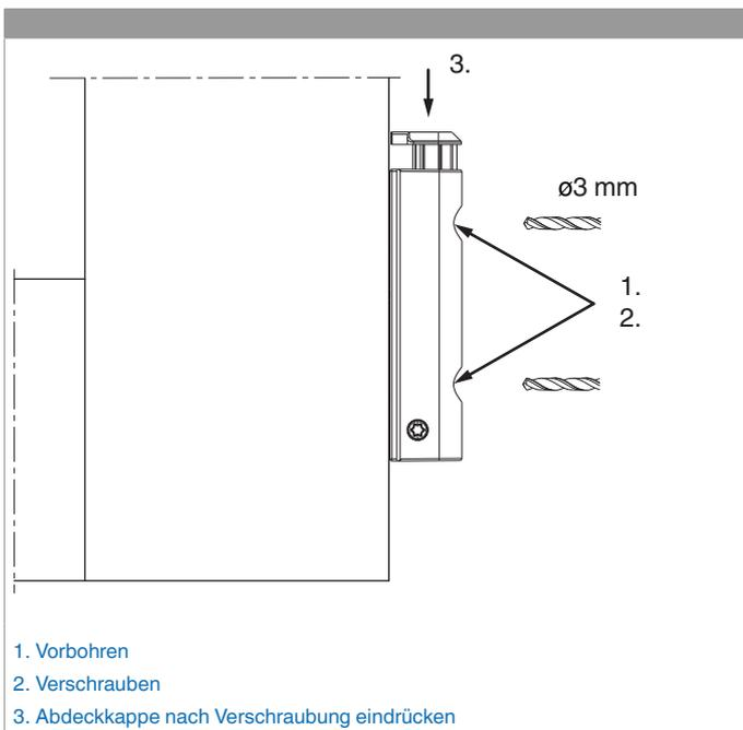
Das Ecklagerband DT mit ÜV für Türen an den Überschlagn anlegen, die beiden Löcher am Überschlagn vorbohren und verschrauben. Falls eine Beschlagsnut am Flügel vorhanden ist, muss eine Winkelbandunterlage verwendet werden.
