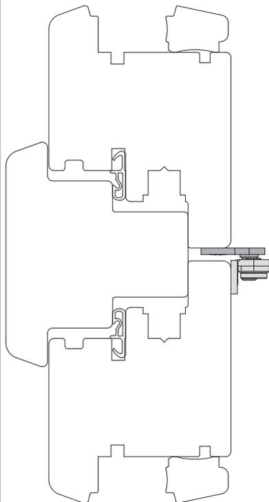
Der Lüftungssteller sollte in der Höhe des Griffes mit Schrauben  $\text{Ø} 4 \times 40$  mm montiert werden.
