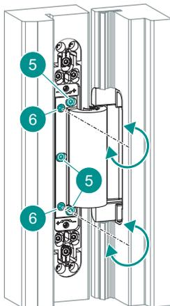
**◻** Andruckverstellung / Depth adjustment / Réglage de la compression de joint / Ajuste de profundidad:
