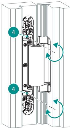
**◁▷** Seitenverstellung / Side adjustment / Réglage latéral / Ajuste lateral:
