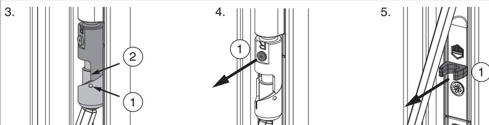
3. Lage der Spindel überprüfen. Bei 90° geöffnetem Flügel muss der Markierungspunkt (1) mit der Kante (2) übereinstimmen.
