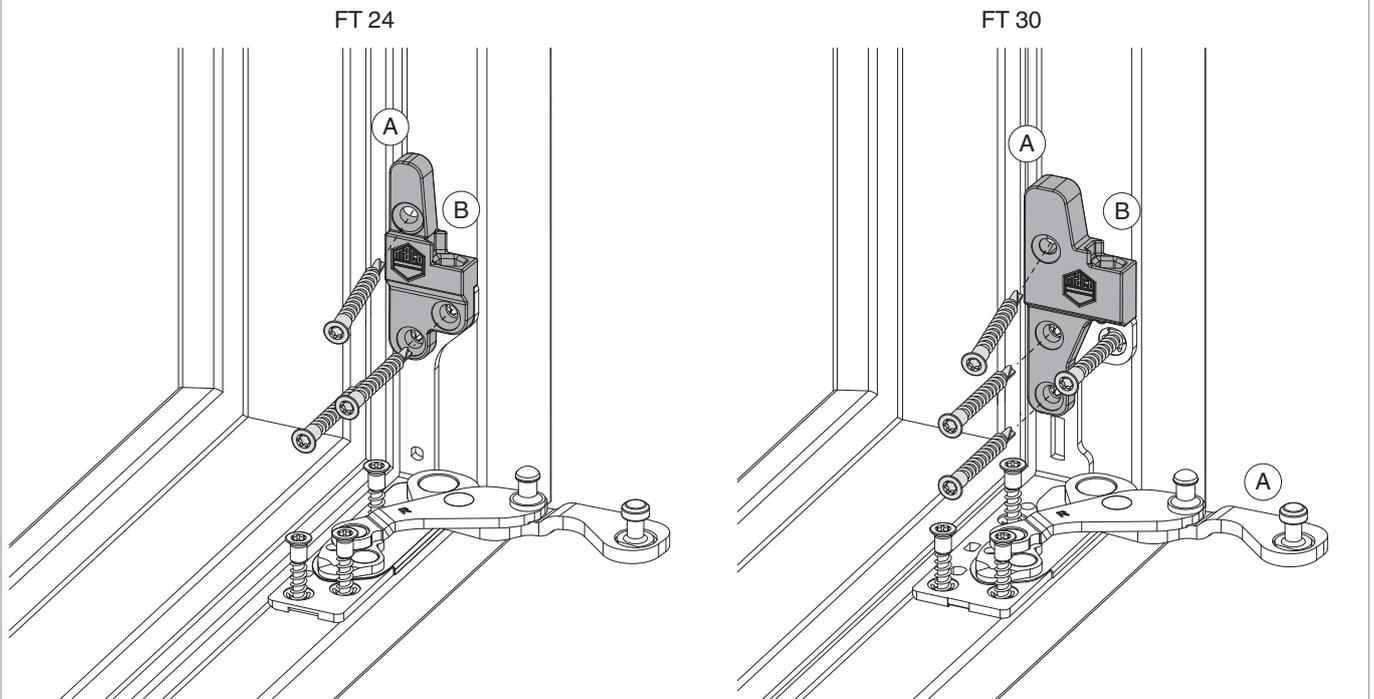
2. Auflager und Ecklager mit Sonderschraube  $\varnothing 4,5 \times 38$  mm (Art. Nr. 362918 bzw. 367828) verschrauben. Eine Schrägverschraubung bei FT24!
