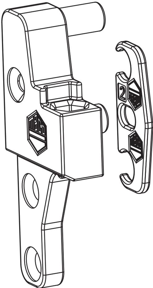
1. Unterlage(n) (A) (Art. Nr. 372008 oder 372009) bei Bedarf auf Auflager aufstecken und Auflager (B) mit den Tragezapfen in die Bohrungen einsetzen.
