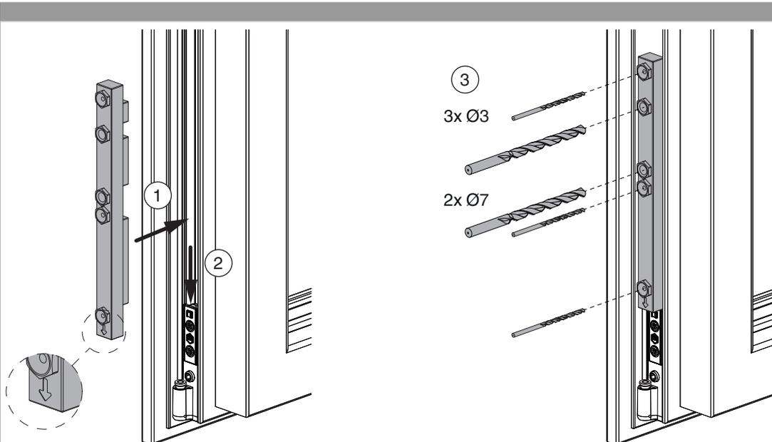
1. Bohrlehre Art. Nr. 228518 lagerichtig (Pfeil nach unten) in Beschlagnut einsetzen.
