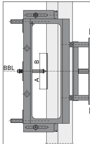
Bandsitz anzeichnen und Universalfräsrahmen mit Mittenanzeiger positionieren.
