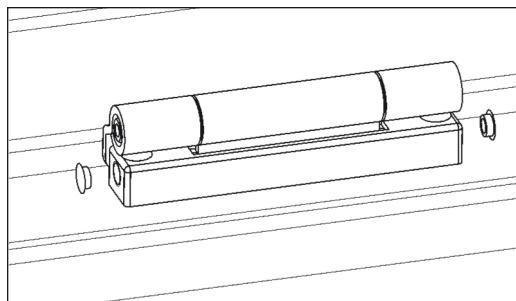
Pro ven otevírává dveře doporučujeme použít variantu se zajištěním čepu (MSTS) proti vlopání.
