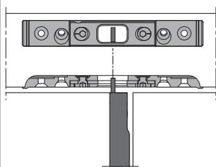
Mitte Stangenausschluss auf Kerbe ausrichten
