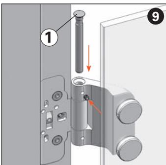
**9** Assemblare la porta con il telaio. Inserire la spina (1) e avvitare il grano solo nel foro dell'anello superiore.
