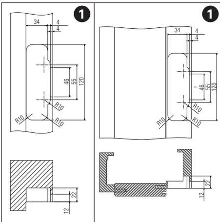
1 Fresare il telaio con l'apposita dima SFS intec per l'alloggiamento tasca secondo le quote indicate nel disegno.
