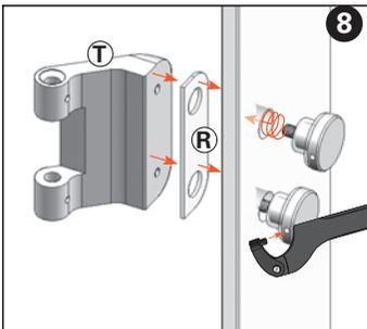
**8** Montare la tasca (T) e la guarnizione (R) sulla porta con gli appositi fissaggi assemblati. Serrare le borchie con l'apposita chiave SFS AW 30 cod. 763931.
