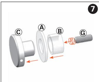
**7** Assemblare il fissaggio infilando la guarnizione (A) e la guarnizione (B) sulla borchia (C) avvitando il grano (G) sulla borchia (C)
