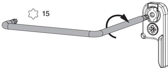
Bajonettverschluß mit TX15 schließen und mit Beschlagsschraube fixieren.
