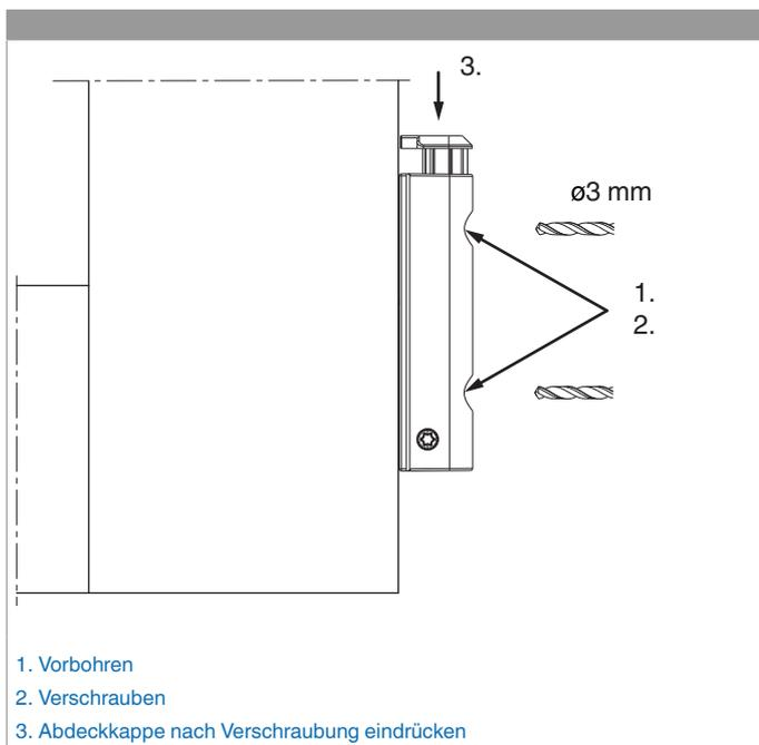
Das Ecklagerband DT mit ÜV für Türen an den Überschlag anlegen, die beiden Löcher am Überschlag vorbohren und verschrauben.
