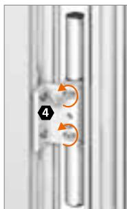
Befestigungsschrauben Flügelbandteil leicht lösen.
