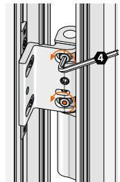
Befestigungs-schrauben Flügelbandteil leicht lösen.
