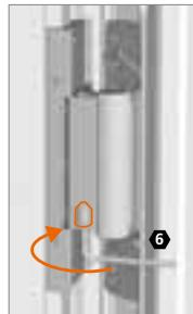
Untere Verstellspindel bei allen Bändern lösen.
