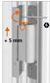
Tür mit oberer Verstellspindel zuerst am unteren Band, dann am oberen Band verstellen.
