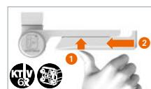
Abdeckstück aufsetzen und einschieben.
