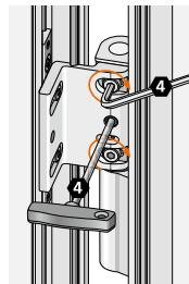
Mit zweitem Inbusschlüssel Befestigungsschrauben wieder anziehen (9–11 Nm).
