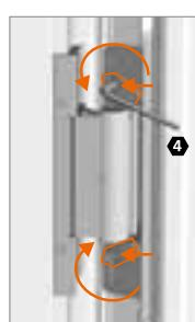
Riegel lösen, ausschwenken und festziehen.
