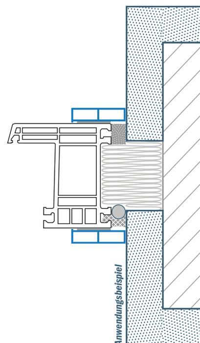
Hohlkammerleisten mit Nase zur Anwendung im Innen- und Außenbereich in weiß. Die Unterseiten sind jeweils gerieft, um eine optimale Verarbeitung bei Kaltverschweißung zu gewährleisten. Zum Schutz vor Kratzern und Verschmutzungen im Folienschlauch verpackt.
