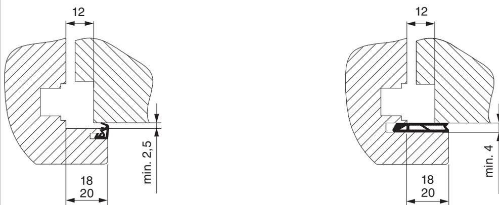
1. Bei Fenstern ohne Überslagsdichtung ist eine Fräsung am Überslag notwendig!
