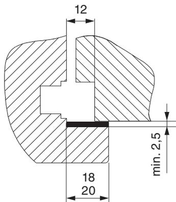
Fräsung am Überschlag für Fenster ohne Überschlagsdichtung.
