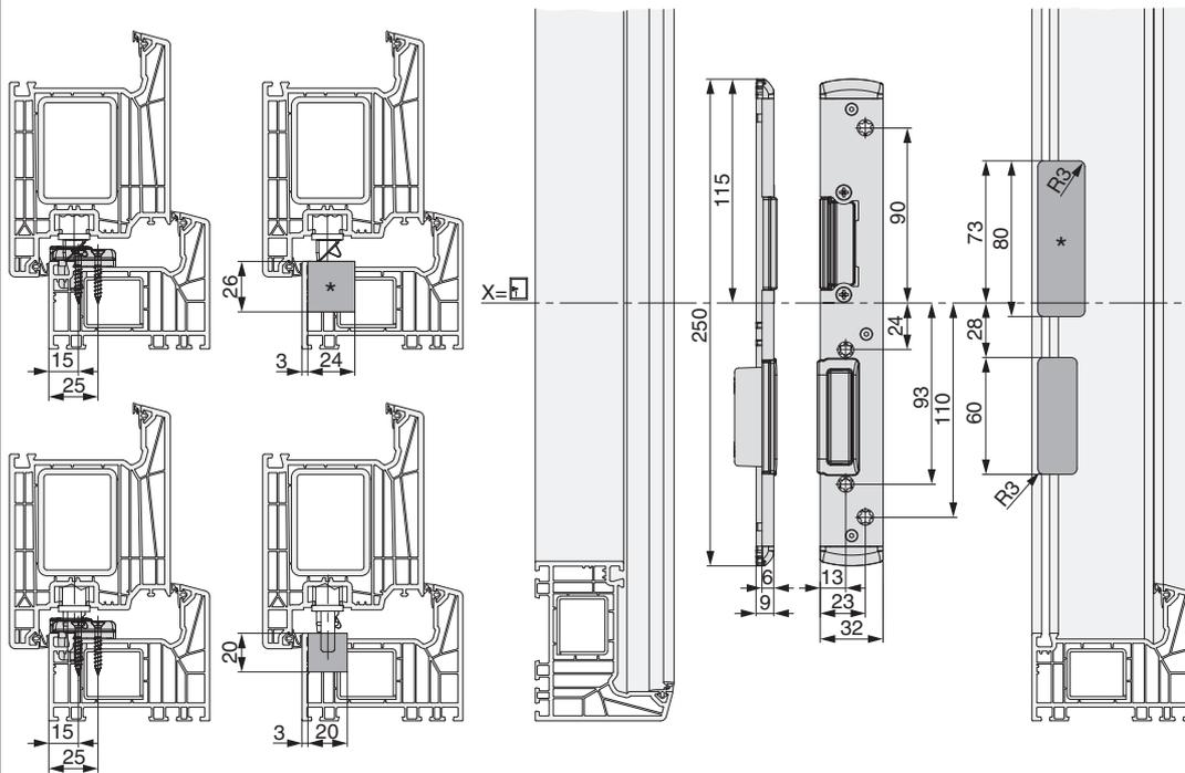
\* Fräsung wird nur bei Verwendung eines E-Öffners benötigt.
