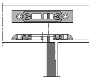
Mitte Stangenausschluss auf Kerbe ausrichten
