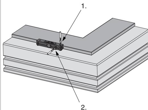
• Bohrungen am Blendrahmen und am Flügel werden bei eingehängtem Flügel durchgeführt.
