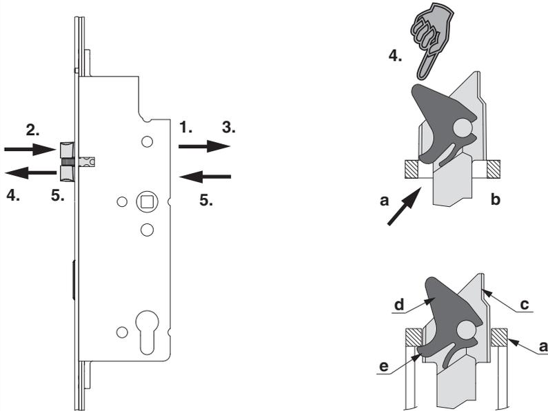
1.) Schraube vollständig lösen und mit Schraubendreher nach vorne drücken.
