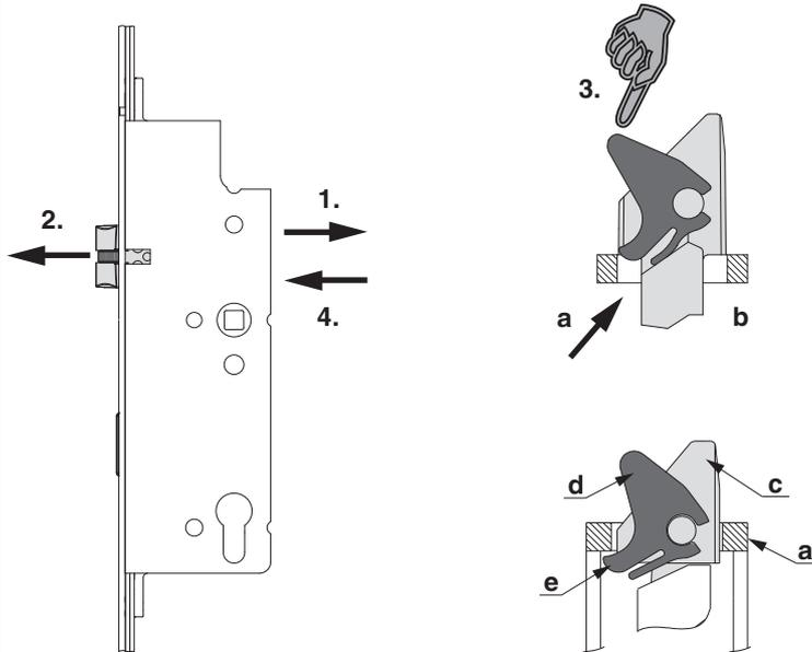
1.) Schraube vollständig lösen und mit Schraubendreher nach vorne drücken.
